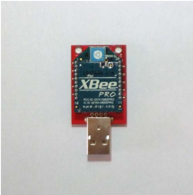
Figura 3. Xbee Explorer Dongle com Xbee Pro de 60mW.
